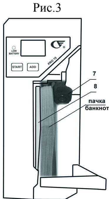
3.6 Нажмите на кнопку «START». Слистывающий ролик 7 начнет вращаться и банкноты будут укладываться на крышку 1. По окончании пересчета банкноты должны лежать ровной стопкой на крышке 1 см. рис. на обложке.
